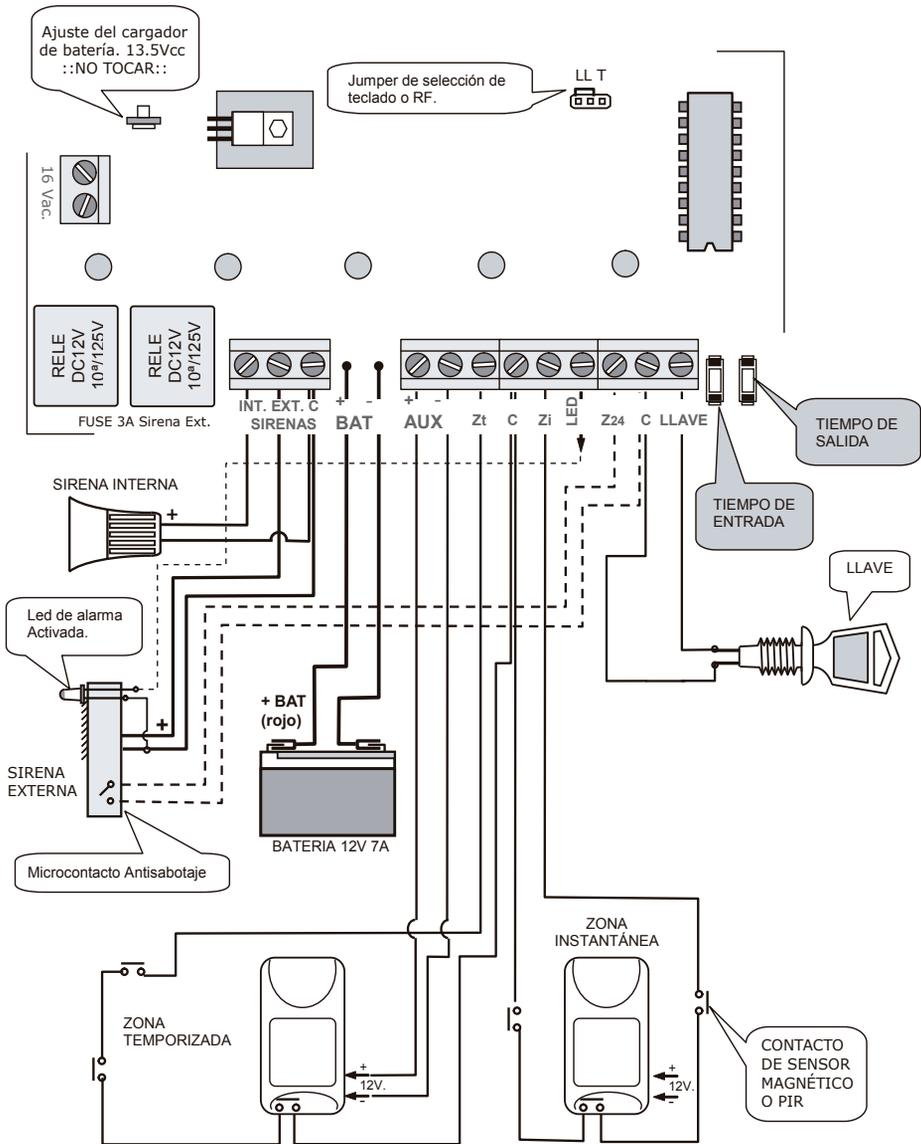
tamper de detectores que estén en el exterior o la utilización de pulsadores de pánico, entre otras cosas. Conecte el terminal Z24 al sensor tamper de la sirena, el otro conductor del tamper tráigalo hasta la central y en la misma conéctelo a un negativo. **Si no utiliza esta zona, hágale un puente a C(común) para cerrar el circuito.**
