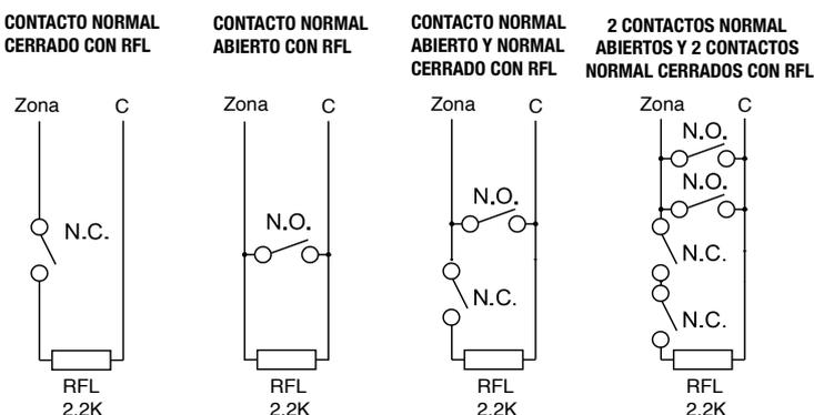
**NOTA:** Este es el modo adecuado de conexión para contactos de detección Normalmente Abiertos (N.O.) o Normalmente Cerrados (N.C.).
