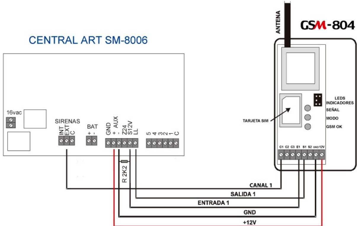
Para conectar el comunicador celular GSM-804 con la central de alarma ART ELECTRÓNICA SM-8006, es necesario cambiar algunos parámetros de la alarma, y cambiar la programación de fábrica del comunicador celular GSM-804.
